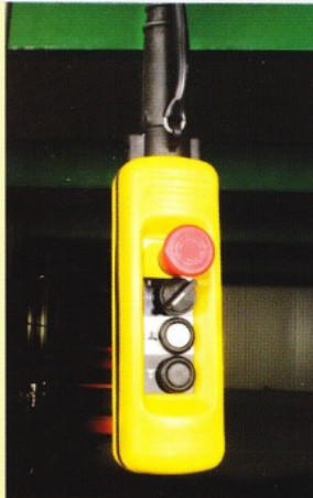
Speciální ovladač pro ovládání dvou kladkostrojů
