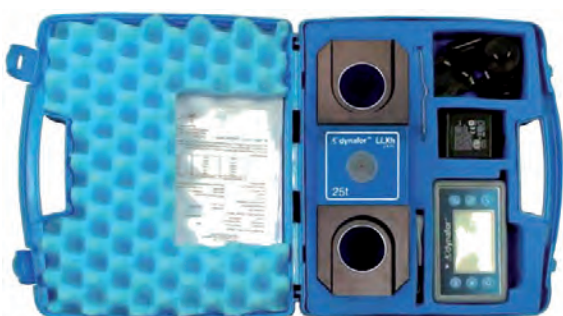
Dynamometry DYNAFOR LLXh jsou dodávány v praktickém plastovém kufru. (provedení 100 t a 250 t v dřevěném kufru)
