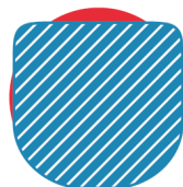
Srovnání profilů řetězového článku tř. 12 a běžného řetězu z kruhové oceli.
