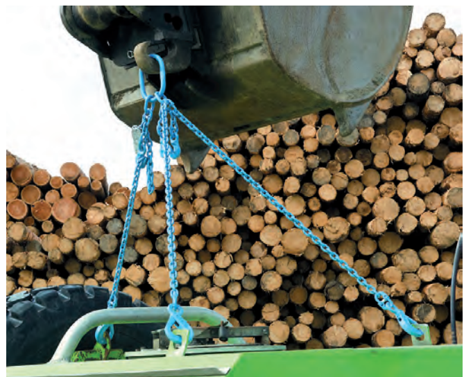
Vysoká odolnost řetězů tř. 12 v pevnosti a tuhosti v ohybu
