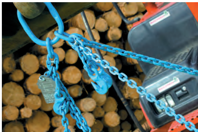
Řetězové úvazky jakostní třídy 12 využívají osvědčený konstrukční systém řetězů třídy 8 a 10.
