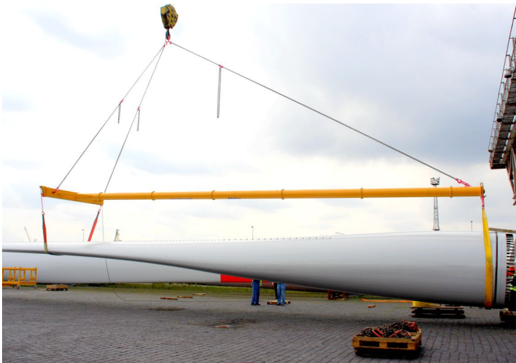
Modulové traverzy se uplatňují při manipulacích s dlouhými břemeny.
