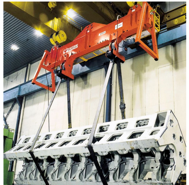
ROTOMAX Vario RVM, nosnost 50 000 kg, manuální nastavení rozteče 1600 - 6000 mm, otáčení elektromotorické pomocí textilních pásů
