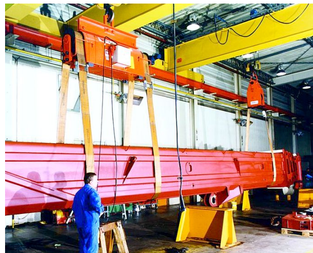
Použití dvou synchronizovaných traverz ROTOMAX Compact R nosnost 10 000 kg (každá), s pevnou roztečí, otáčení elektromotorické pomocí textilních pásů
