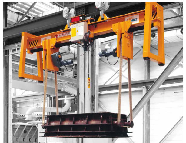
ROTOMAX Vario RVE, nosnost 12 000 kg, elektromotorické nastavení rozteče 1700 - 5000 mm, elektromotorické otáčení pomocí textilních pásů
