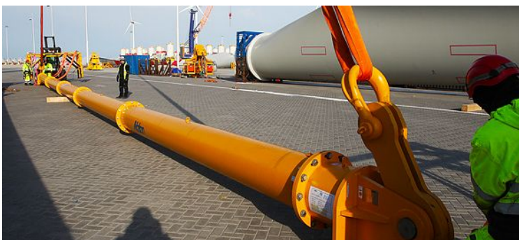
Pomocí modulů lze sestavovat traverzu libovolné délky od 1 m až do délky několika desítek metrů.
