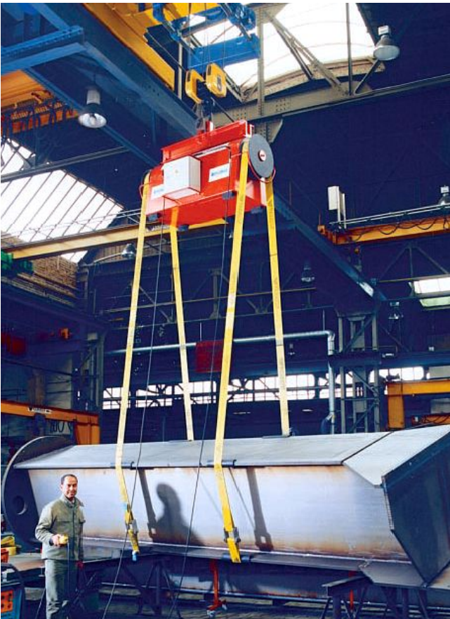
ROTOMAX Compact R nosnost 10 000 kg, s pevnou roztečí, otáčení elektromotorické pomocí textilních pásů
