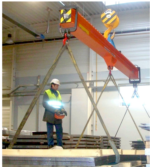
Jeřábová traverza stavitelná se 2 pohyblivými jezdci s hákem a 1 středovým hákem.
