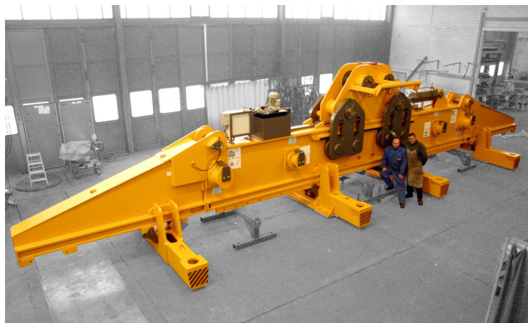
Jeřábová traverza vyvažovací o nosnosti 380 t určená pro manipulace s turbínami v jaderné elektrárně. Posun závěsného oka je ovládán rádiovým ovládním a je poháněn elektro-hydraulicky.
