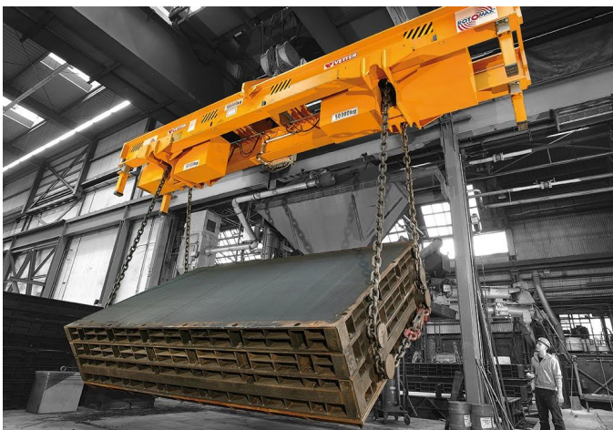
ROTOMAX Vario RVE, nosnost 100 000 kg, elektromotorické nastavení rozteče 2900 - 7000 mm, elektromotorické otáčení pomocí řetězů
