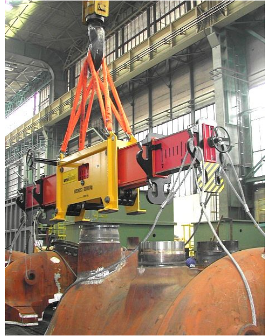
Jeřábová traverza stavitelná teleskopická s bočními háky. Ovládání vysouvání ramen je pomocí ovládacího kola.
