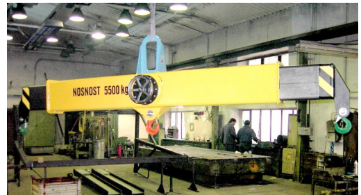
Jeřábová traverza stavitelná teleskopická s pevnými háky. Ovládání vysouvání ramen je pomocí ovládacího kola.
