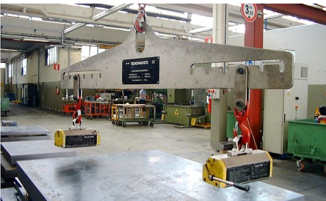
Jednoduchá stavitelná jeřábová traverza při použití s dvěma břemenovými magnety
