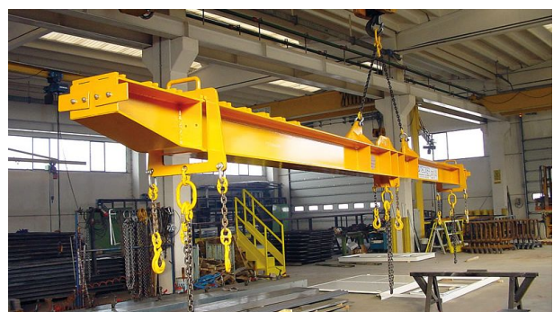
Jeřábová traverza stavitelná s 2-pramenným závěsem, dvěma přestavitelnými jezdci a pevným středovým závěsem. Každý závěs je určen pro připojení 3 vázacích řetězů.
