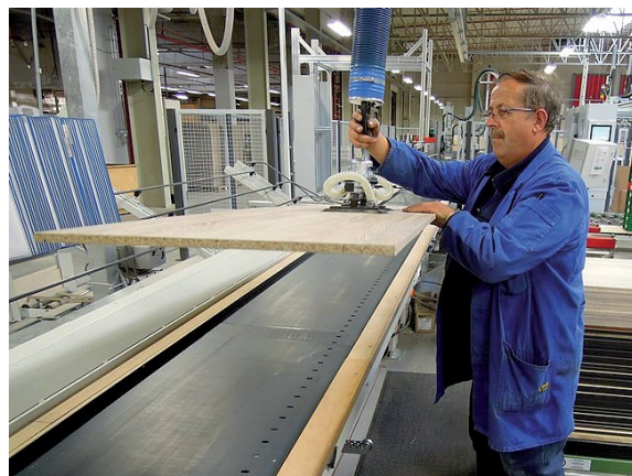
Manipulace dřevěných desek pomocí manipulátoru Vacu-Quicklift VQL
