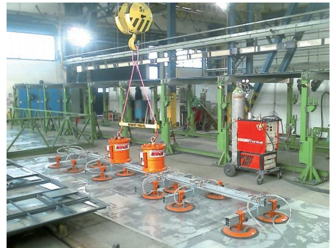
Vakuový manipulátor VMS o nosnosti 500 kg s 12 přísavkami pro manipulaci dlouhých tenkých plechů
