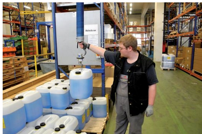
Manipulace plastových kanystrů pomocí manipulátoru VQL s mechanickým chapadlem
