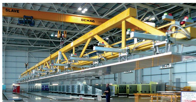
VacuGiant VG při transportu 36 m dlouhého hliníkového dílu o hmotnosti 4,5 t při výrobě křídla pro Airbus A380.
