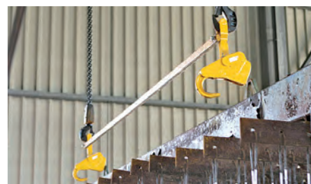
V případě současného použití dvou háků Meimatic je synchronizace zajištěna pomocí rozpěry.
