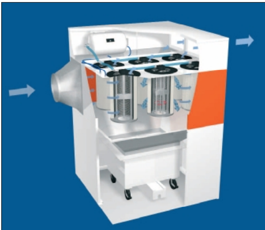
Průřez filtrační částí centrálního zařízení systému 9000
