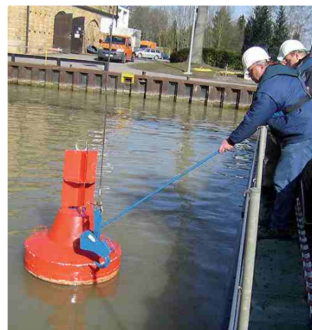
Při připojování automatického háku Meimatic lze použít naváděcí tyč. Na obrázku manipulace s bóji.
